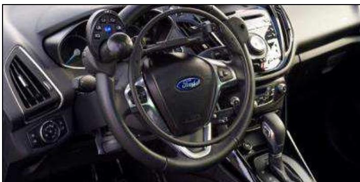
Volante adaptado. Volante y cambio marchas adaptado (manejado con un joystick)
