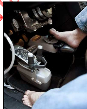
Volante adaptado. Volante y cambio marchas adaptado (manejado con un joystick)
